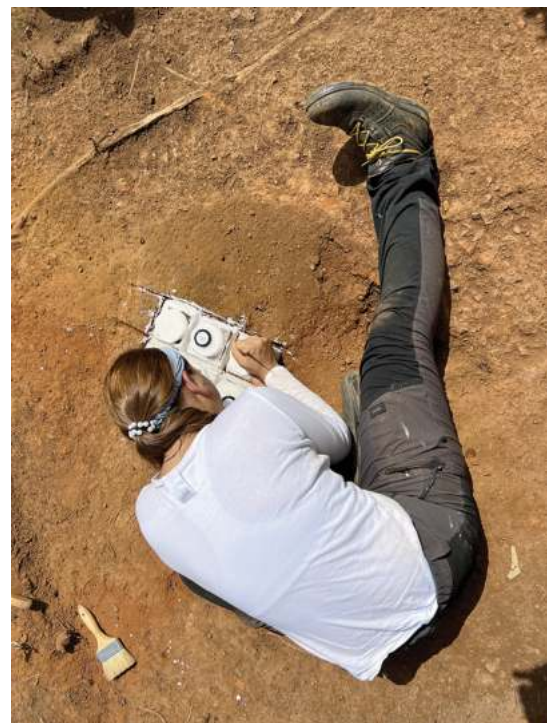
Georgia Ricci, doctorante recrutée dans le projet OBTAAIN, en train de prélever des échantillons de paroi de four du site de Tchogma 1 (Togo) en vue d'analyses archéomagnétiques
