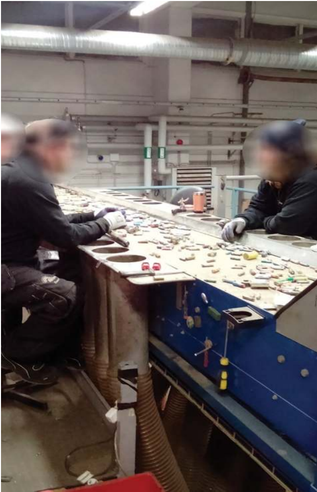
Opératrices et opérateurs de tri de batteries usagés discutant des dangers d'explosion © Bahers, 2019
